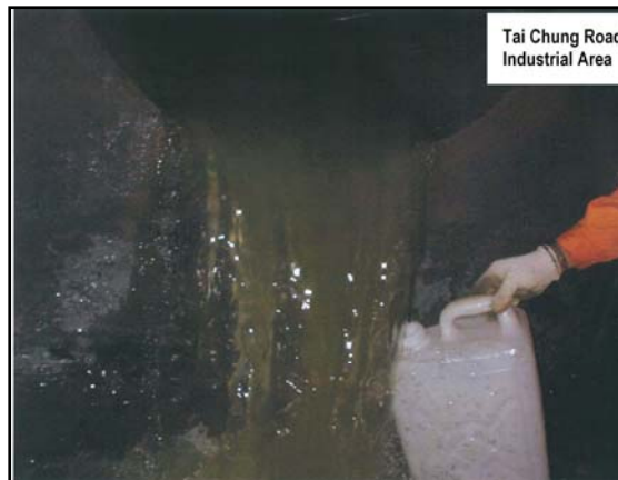
圖片 6 - 在進沿著箱形雨水渠的分支上採集樣本的情況
