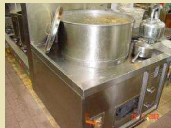
噴咀混合式平底爐頭 約 200
