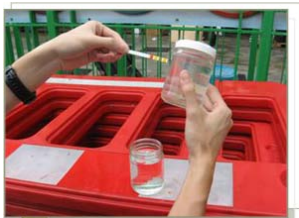
於污水處理設施抽取和檢視水樣本作監控
