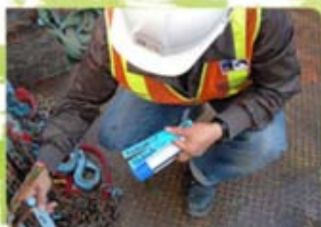
檢查起重裝置
