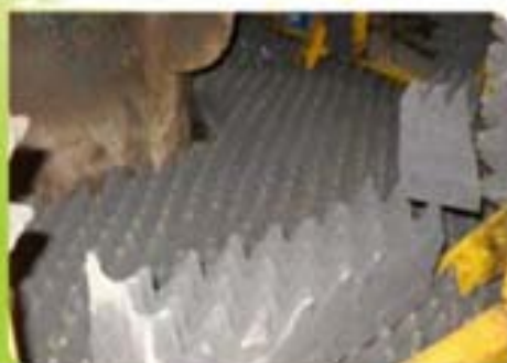
油壓錘內的隔聲物料 6
