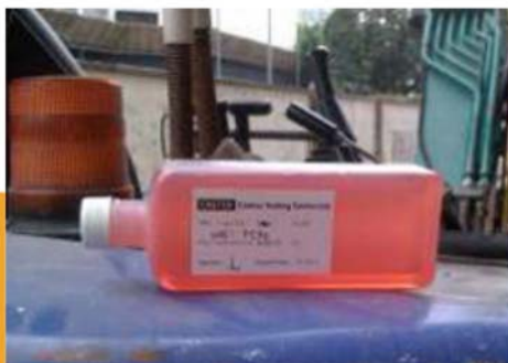
採用超低硫柴油，並定期在工地 監測燃油，減少空氣污染
