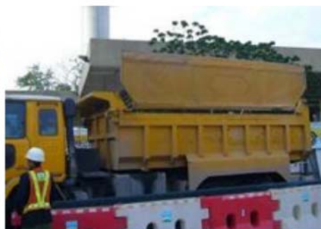
泥頭車用機械閘封蓋
