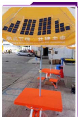
利用太陽能光伏板發電驅動風機
