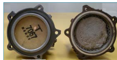
全新的催化器（左）和積聚了車輛引擎廢氣微粒的舊催化器（右）。
