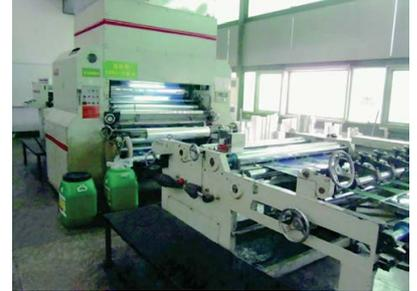
珠三角地區一間港資工廠參加清潔生產伙伴計劃，通過把覆膜工序由原來採用傳統溶劑性膠水改為水性膠漿，每年減少8萬公升天拿水用量，達致大幅減低揮發性有機化合物排放量63公噸，並節省成本35萬元。
