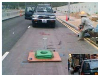
排水能力測試 — 用以量度水傳導性能
