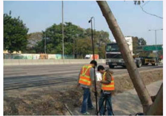
量度粉嶺公路低噪音路面的噪音
