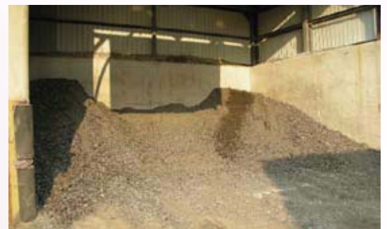
從現有瀝青路面刨起以待循環再造的瀝青物料
