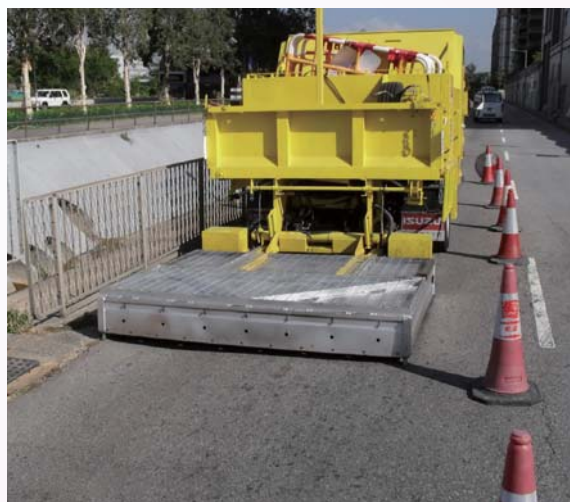
正在運作的熱能修路機
