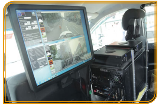
車內裝設的移動道路測量電腦系統
