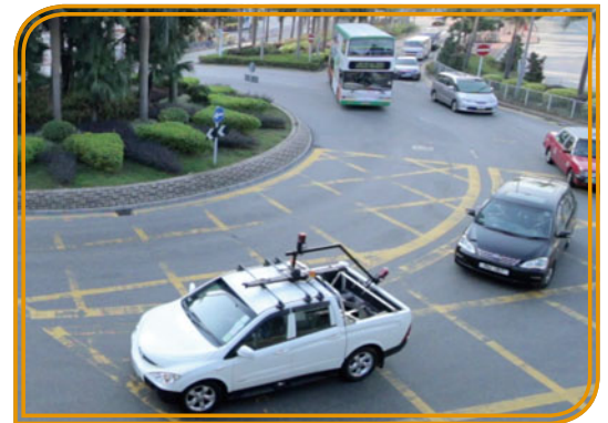
採集道路設施資料只需動用一輛配備移動道路測量系統的車輛
