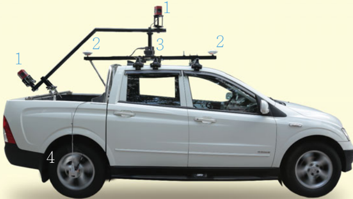
圖1 - 移動道路測量系統的流動平台
