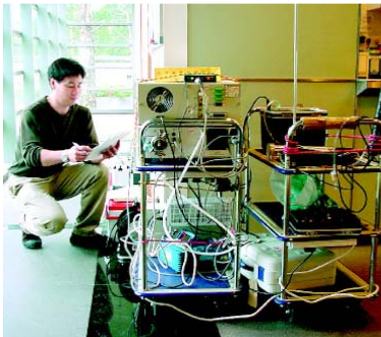
員工正在完成的工程項目內量度室內空氣質素。
