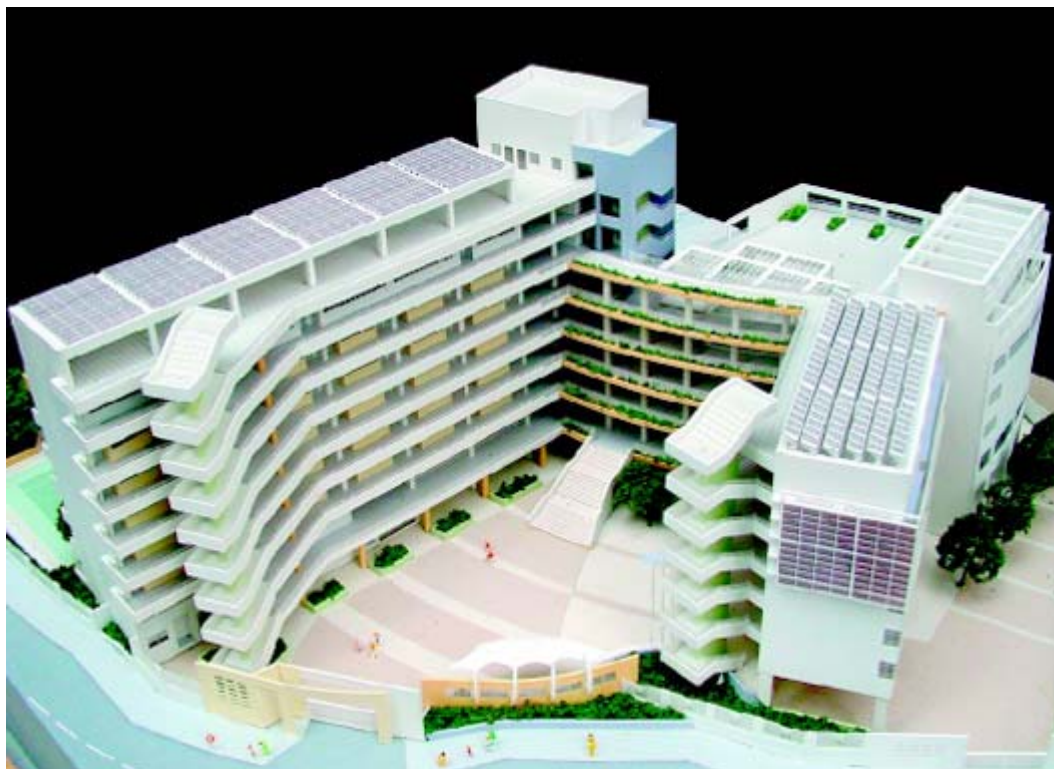
計劃裝置在馬灣小學屋頂和西面外牆的建築構件式太陽能光電板。
