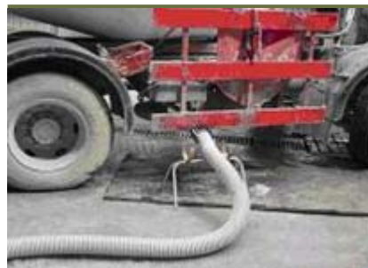
車輛噴出的廢氣，經特製過濾系統處理
