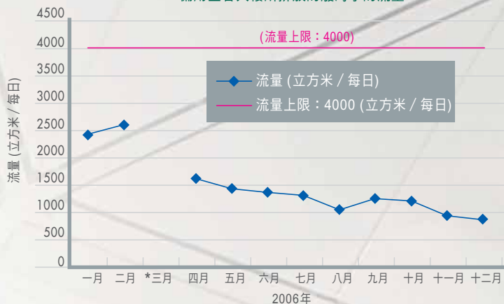
備用空管大樓所排放的廢海水的流量
