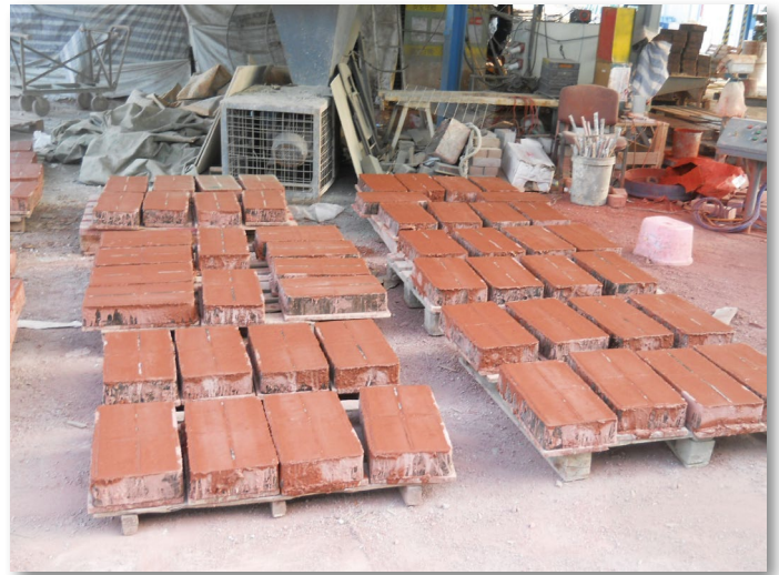
以水泥加固海泥製造的鋪路磚
