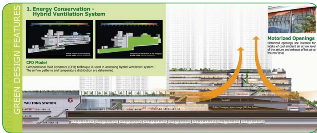
油塘全新的「大本型」商場結合自然通風和空氣調節的混合式通風系統的示意圖
