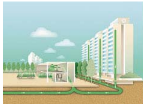
自動垃圾收集系統在完全 密封的環境下收集垃圾， 令衛生環境得到顯著改善
