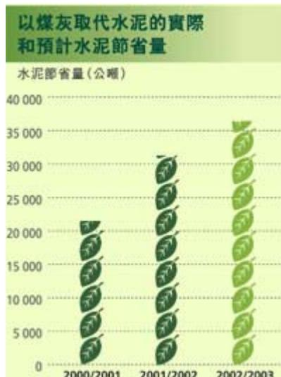
爲了節省水泥，我們要求承建商使用煤灰來取代部分水泥。於2001年10月開始，我們訂明地基工程必須將水泥節省量由25%增至35%，並且准許承建商在某些上層結構組件中使用最多25%的煤灰。去年，承建商進一步節省31 200公噸水泥，預期來年會進一步節省36 000公噸。
