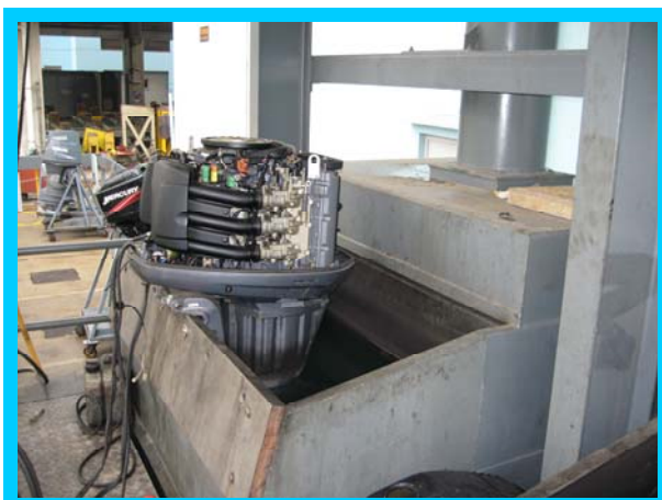
廢氣抽除系統可抽除輪機在測試期間所排放的廢氣
