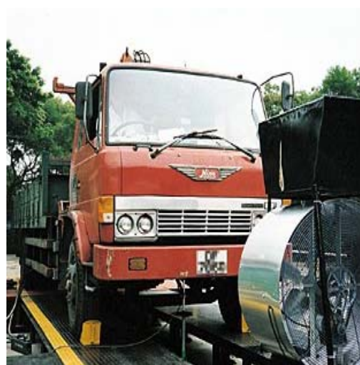
正在接受測功機測試的貨車
