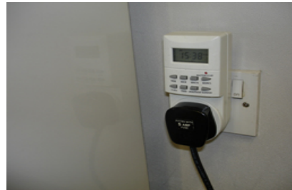
在蒸餾水機安裝7日時間掣，可在辦公時間後自動關掉水機的電源。
