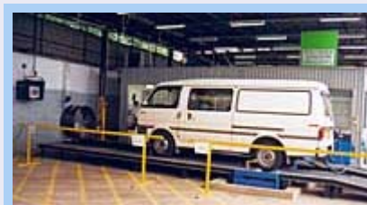
利用底盤式功率機測試黑煙
